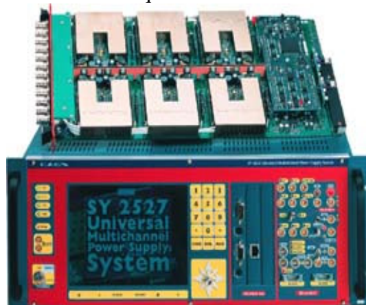
Fig 22 : L'alimentation et une de ses cartes
