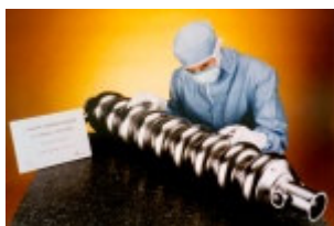
Fig 4 : Élément supraconducteur d'une ligne accélératrice
