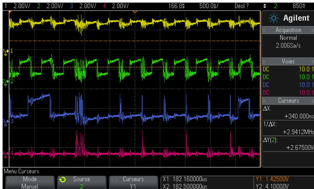
FIGURE 3.13 – Signaux de configuration de MAROC par mezzanine
