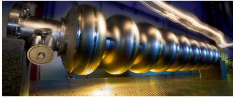
Figure 4 : Une structure de neuf cavités accélératrices
