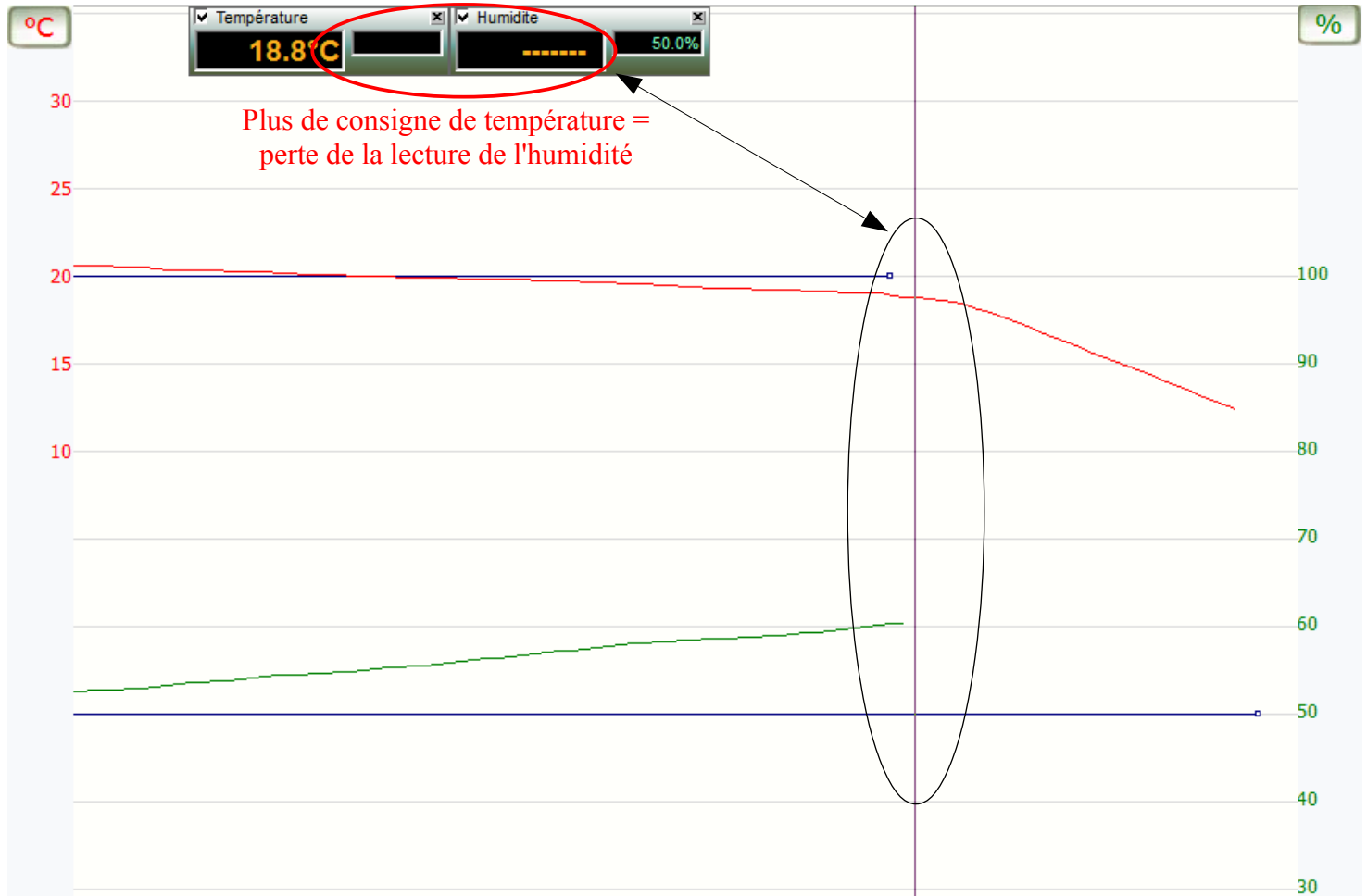
Consigne d'humidité qui s'arrête 1 minute après celle de la température
