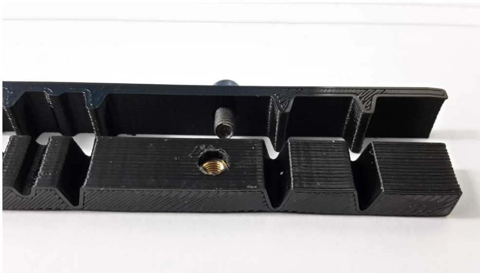
Photographie d'un bout de réglette après impression et perçage
